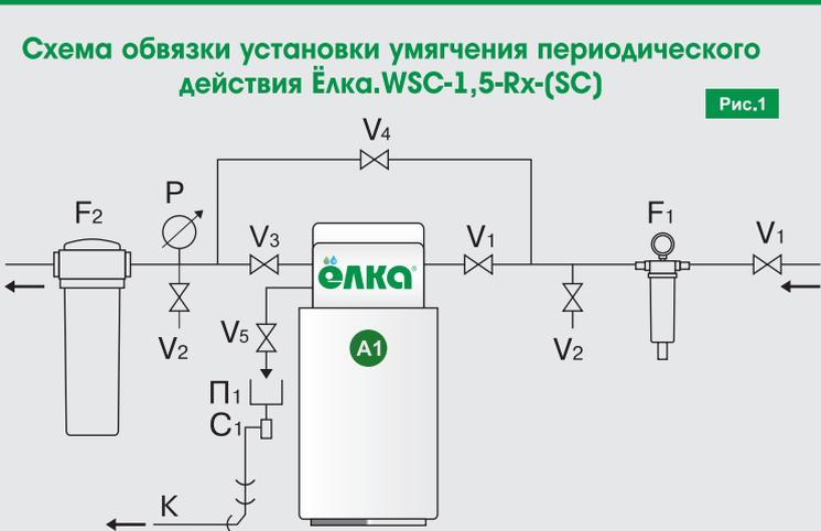
В1 - шаровый кран, F1\* - фильтр грубой очистки с манометром, V2 - пробоотборный кран, A1 - Ёлка.WSC-1,5-Rx-(SC), V3 - вентиль настройки номинального расхода, V4 - вентиль регулировки жесткости, V5 - вентиль настройки промывного расхода, P - манометр, F2 - картриджный фильтр тонкой очистки, П1\*\* - приемная воронка с разрывом струи, С1\*\* - гидравлический затвор, К - безнапорная канализация.
