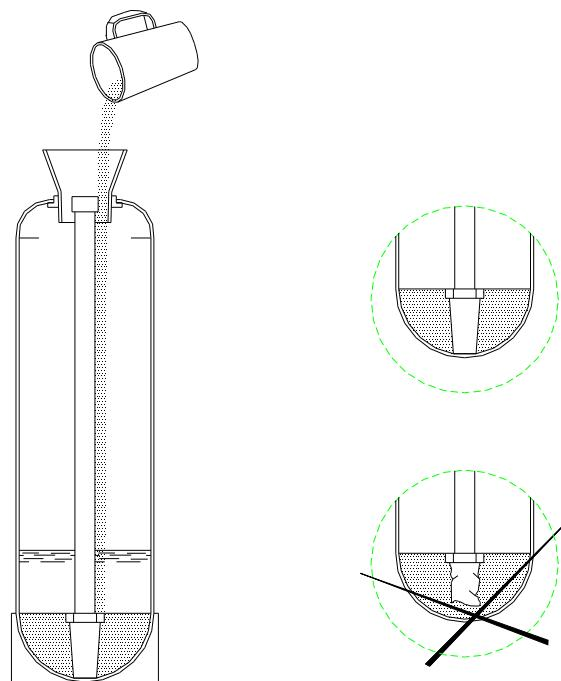
Рисунок 3 — Порядок загрузки фильтрующего материала в корпус фильтра
