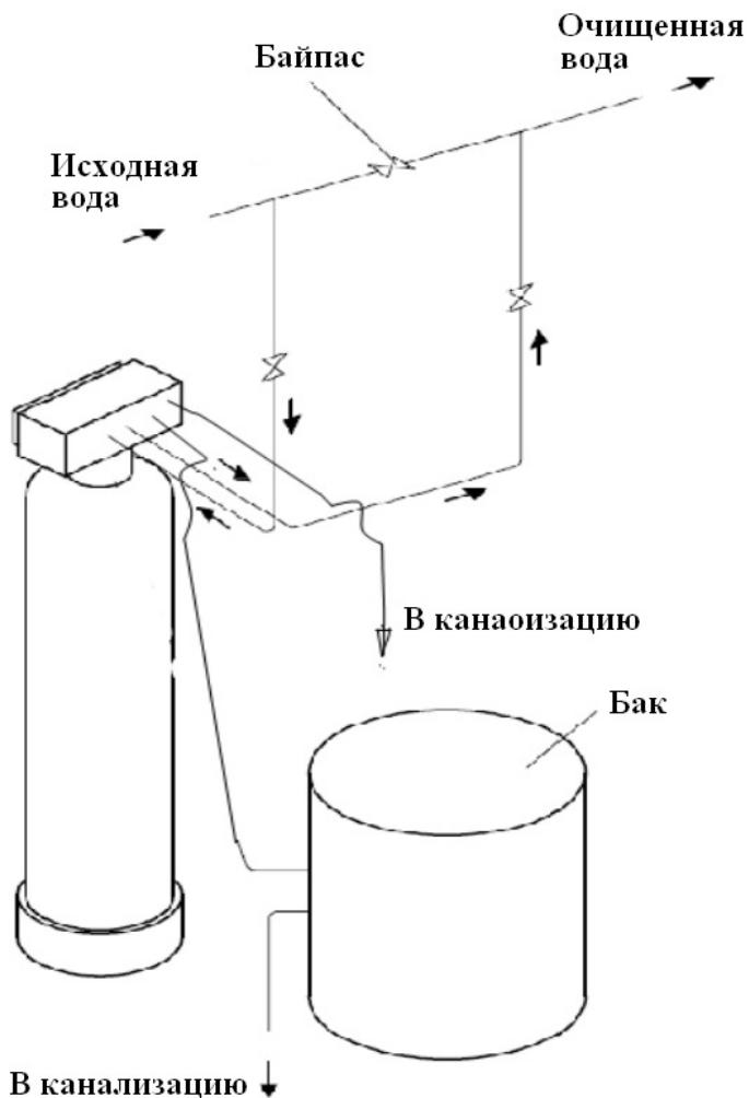
Рисунок 2 — Схема монтажа установки умягчения воды переодического действия WS - 3/4" и 1"
