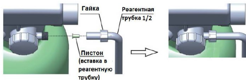
Рисунок 4 — Подключение реагентной линии в установках WS-5,0-Rx-(BS)-WS-8,0-Rx-(BS)
