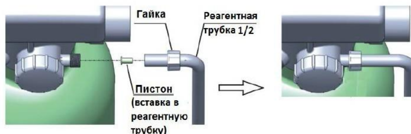
Рисунок 4 — Подключение реагентной линии в установках WS-5,0-Rx-(BS)-WS-8,0-Rx-(BS)
