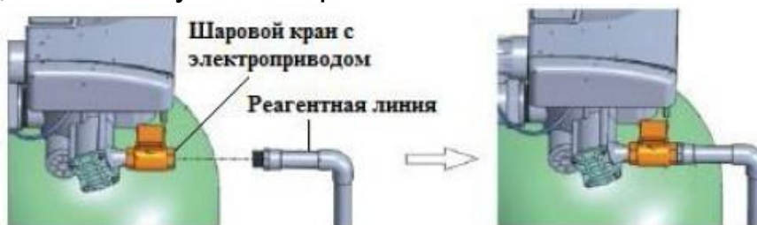
Рисунок 5 — Подключение реагентной линии в установках WS-13,0-Rx-(BS)-WS-20,0-Rx-(BS)
