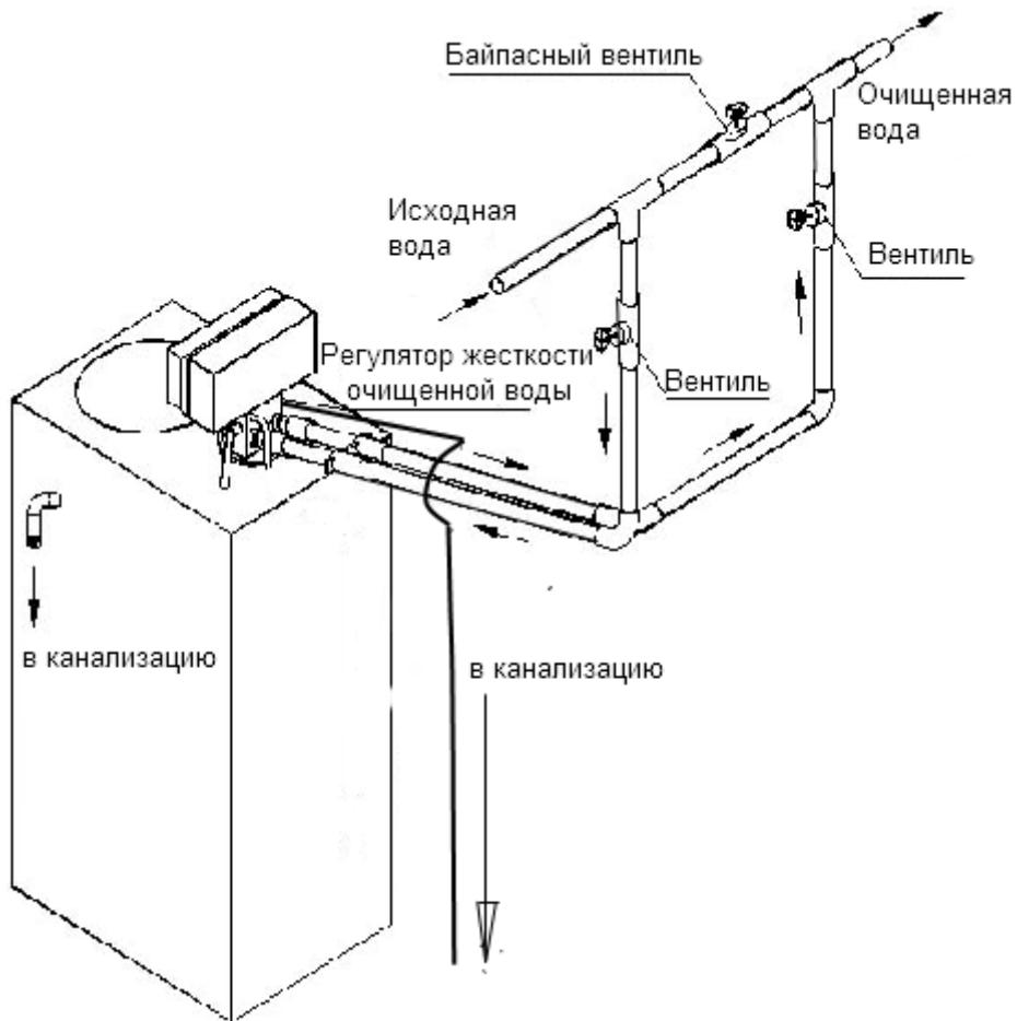
Рисунок 2 – Схема монтажа установки умягчения и обезжелезивания воды периодического действия типа “Кабинет” WSDF
