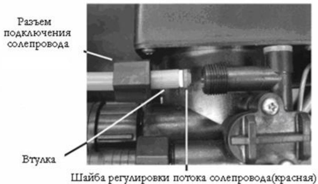
Рис.7 Метод правильно выполненной установки.
