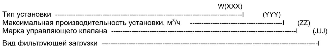
Рисунок 1 — Структура обозначения установки
