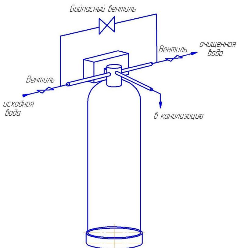
Рисунок 2— Схема монтажа установки сорбционной WFC-1,31...4,0 -Rx-(ACC).
