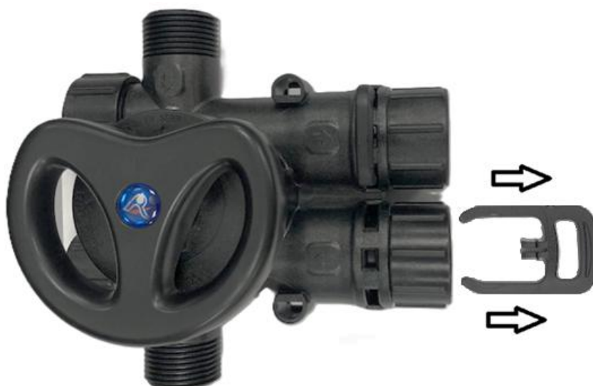
Рис. 6.2 Разборка клапана-байпаса TM.F70A с крыльчаткой в сборе: этап 1. Снятие клипсы.
