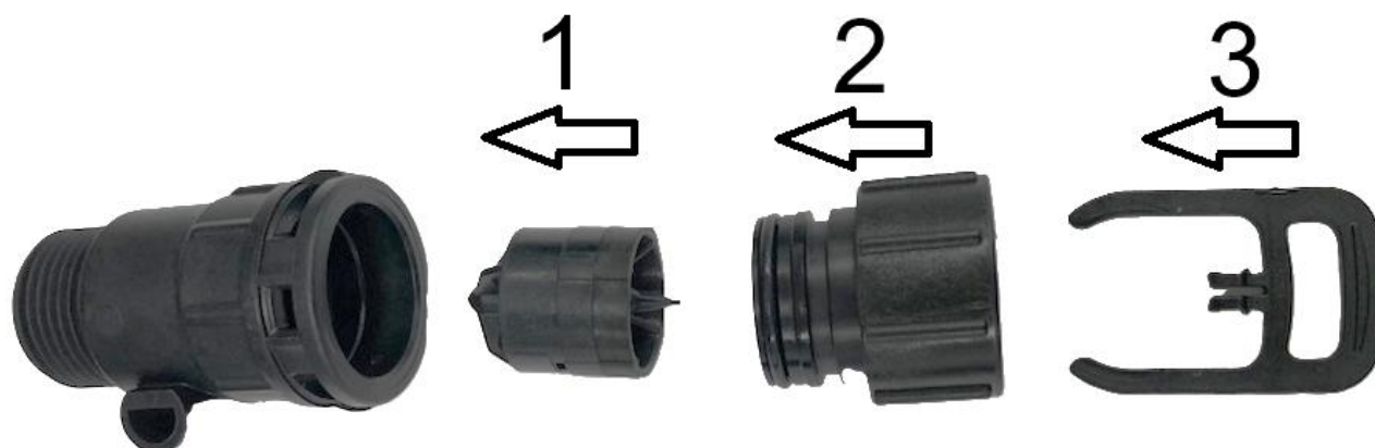
Рис. 6.9 Сборка патрубка очищенной воды управляющего клапана: Этап 1 – вставить крыльчатку водосчетчика; Этап 2 – вставить резьбовой патрубок; Этап 3 – вставить клипсу.
