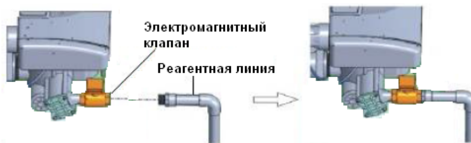
Рисунок 4 — Подключение реагентной линии в установке WS-34,0-Rx-(BS)
