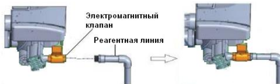
Рисунок 4 — Подключение реагентной линии в установке WS-34,0-Rx-(BS)
